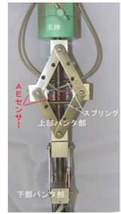
写真-5 AE 装置のパンタ部<sup>6),7)</sup>
