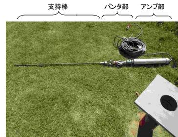
写真-6 ロッドを取り付けた AE 装置と孔口<sup>6)</sup>
