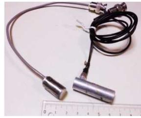
写真-4 開発した小型センサー (左)と市販のセンサー(右)<sup>7)</sup>
