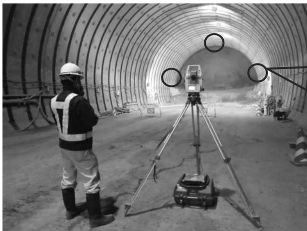
3～5箇所ターゲットを設置してその点の変位を光波測定器にて測定する。
