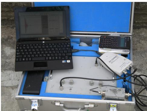
写真-1 高周波衝撃弾性波法の調査装置
