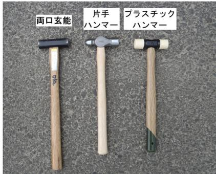
写真-2 実験に用いたハンマー
