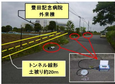
写真-3 地上の振動計測点
