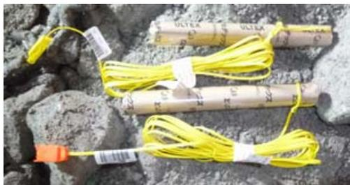
写真-2 親ダイ（高精度電子雷管 (eDev II)）
