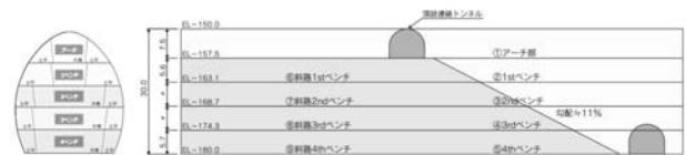
図-9 貯槽加背割り掘削ステップ
