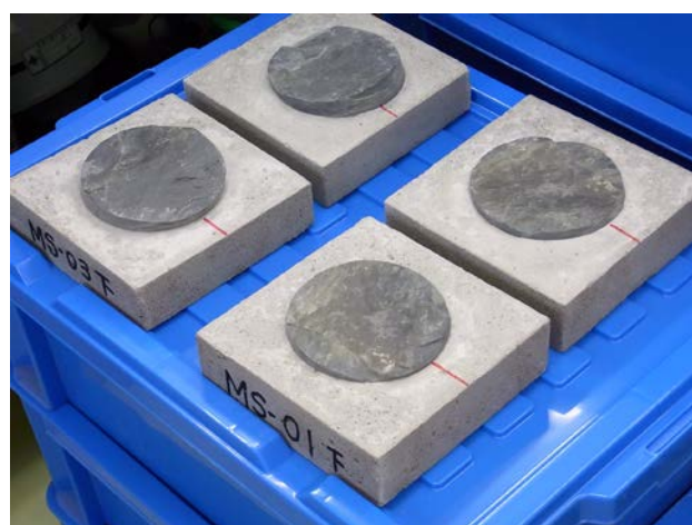
写真-1 岩盤不連続面の試験供試体(泥質岩層理面)
