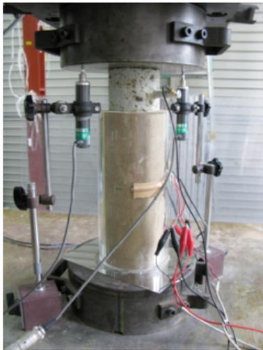
図-2 残柱式空洞模型載荷実験
