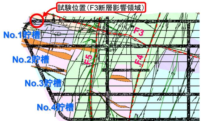
図-1 試験実施位置図(地質平面図(EL-167.5m))
