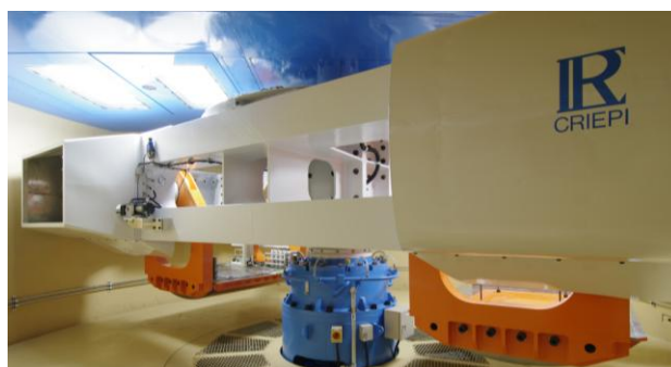
図-2 本実験で用いた遠心力载荷装置の写真。
