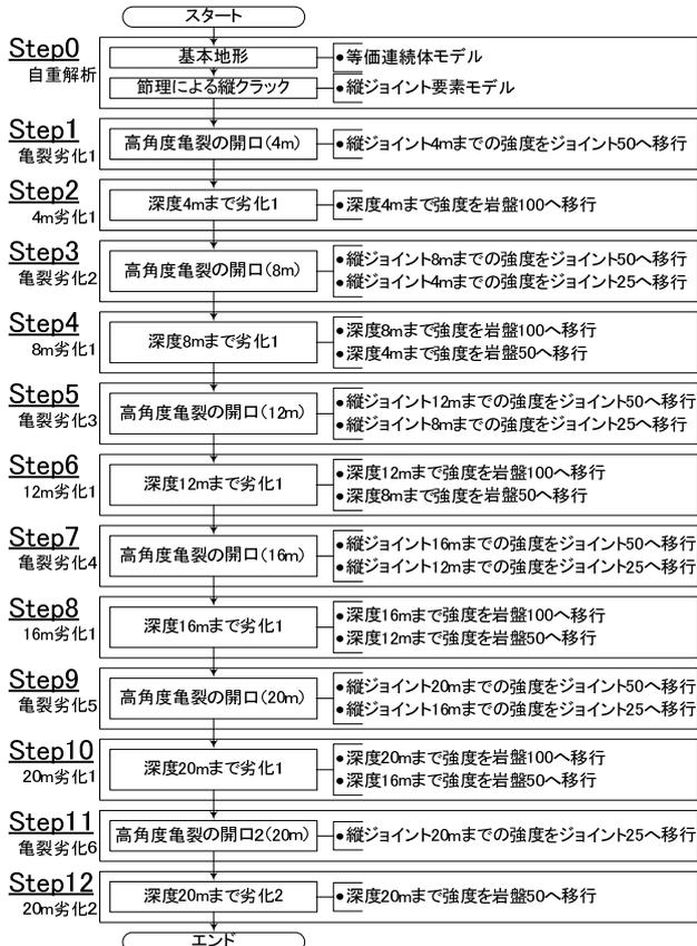
図-6 解析フロー (トッピング型) (文献3)に加筆修正)
