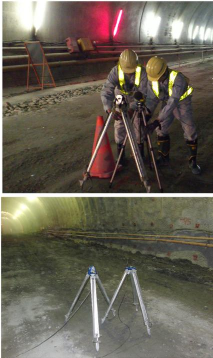
写真-1 発破音の測定状況
