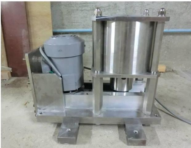
写真-1 作製した遠心引張り試験装置
