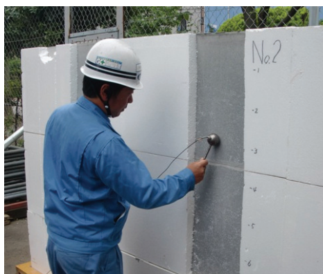
写真-2 通常法による打球探査試験状況
