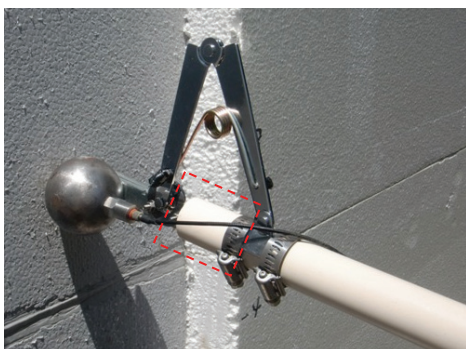
写真-4 突き棒法の先端（改良後）
