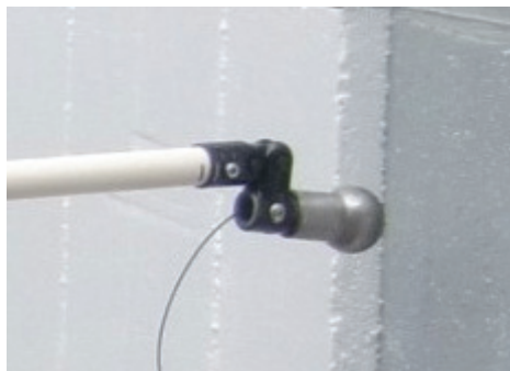
写真-3 突き棒法の先端（改良前）
