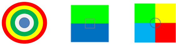
変位量絶対値 上下の変位 4象限の変位 図-6 目的に応じた光源の形
