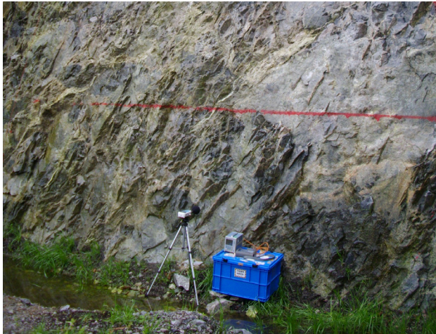
写真-2 坑口法面（音響放射面）に設置した測定機器の状況
