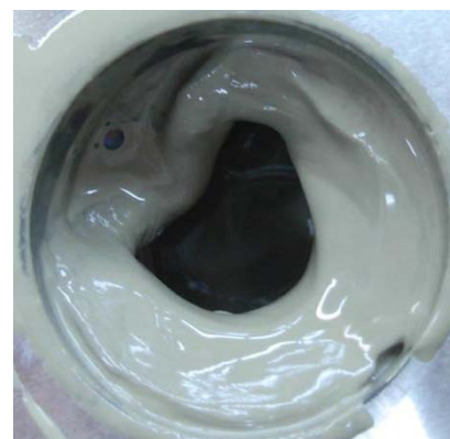
図-15 試験終了後のスリット内側のフィルターケーキ (注入圧力0.1MPa, 上: 超微粒子セメント, 下: 球形化した超微粒子セメント)
