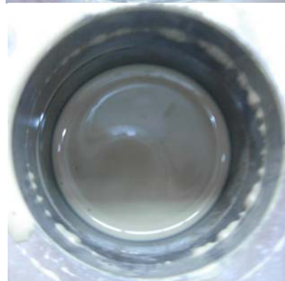
図-15 試験終了後のスリット内側のフィルターケーキ (注入圧力0.1MPa, 上: 超微粒子セメント, 下: 球形化した超微粒子セメント)
