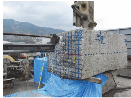
写真-1 岩石ブロックに対するさく孔実験状況
