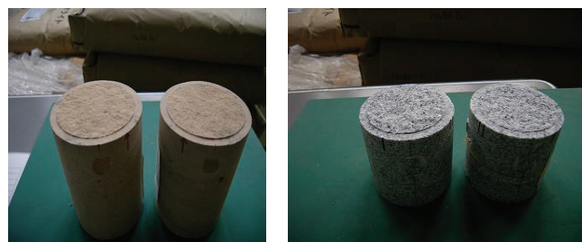
図-5 亀裂面の状況（左：砂岩 右：花崗岩）
