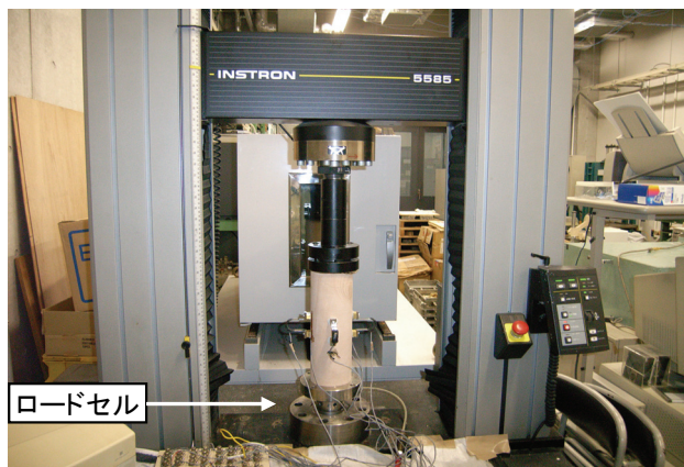
図-6 荷重およびひずみ計測状況
