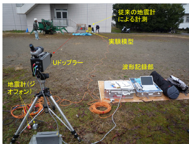
図-2 土砂斜面模型実験の実験装置配置 9)
