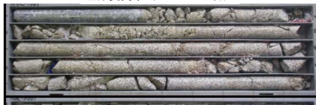
写真-2 左岸変質帯の代表コア写真
