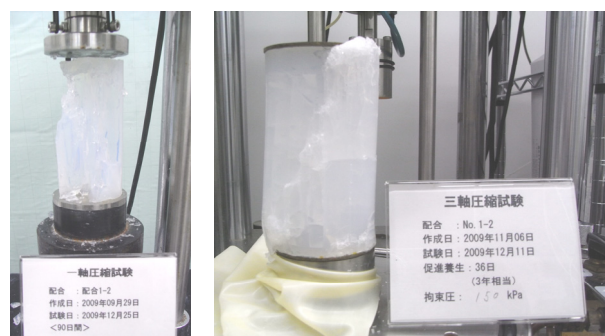
図-3 せん断試験後の破壊状況(左;一軸圧縮試験, 右;三軸圧縮試験)
