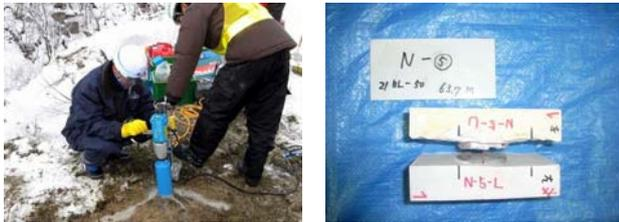
図-11 供試体の採取状況および供試体
