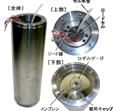
写真-1 新しい三軸セルの外観
