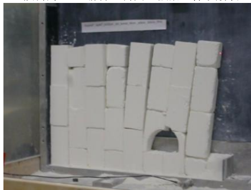
図-12 傾斜角90°の場合の斜面の振動に伴う崩壊の様子
