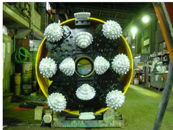
写真-2 φ1,100mm 破碎型掘進機前面
