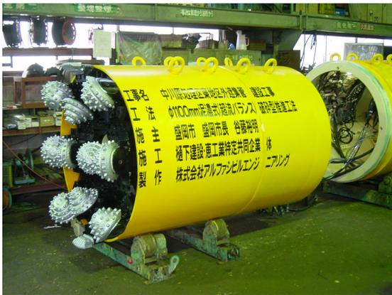
写真-1 φ1,100mm 破碎型掘進機全景
