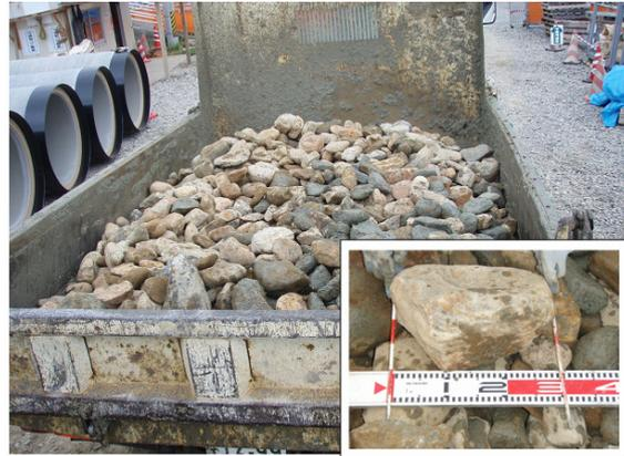
写真-6 破碎後掘進機排土貯留槽より分級された大割礫群
