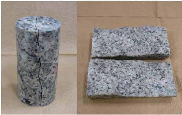
写真-1 縦割れ亀裂を有する花崗岩供試体
