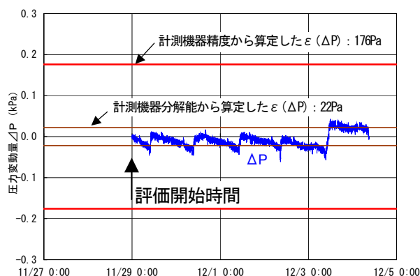
図-14 補正後圧力変動量 \Delta P (気密試験 0.7MPa 安定時)
