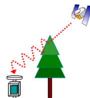
(b) 上空障害物による電波の乱れ
