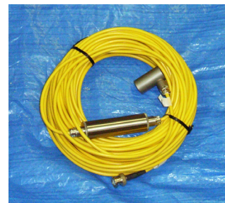
図-4 AE震源位置評定法におけるAEセンサおよび設置筐体
