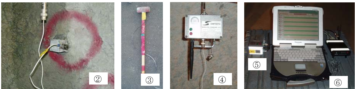
写真-2 無線式 TRT 探査システムの構成機器
