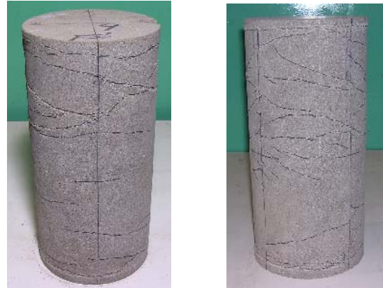
写真-3 破壊状態 (左: xy载荷. 右: z除荷) (亀裂はトレースして強調してある)
