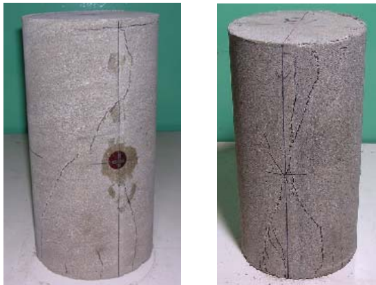
写真-2 破壊状態 (左: z 载荷. 右: xy除荷) (亀裂はトレースして強調してある)
