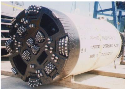
写真-1 面盤フェイス型：破碎型掘進機
