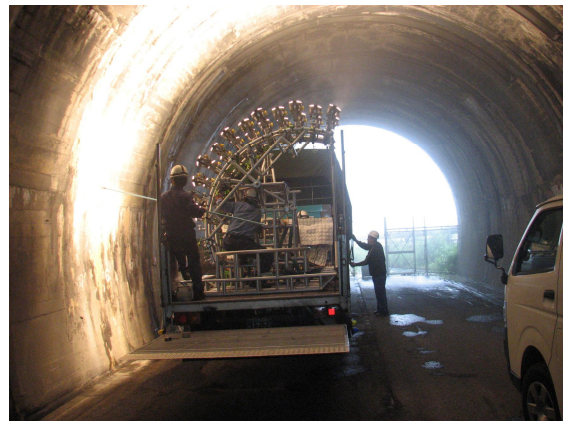
図-2 走行型画像計測の概観
