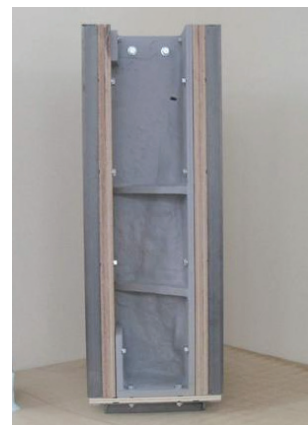
写真-3 模型型枠
