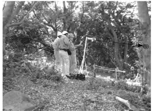
図-2 通信試験の状況 (指向性のアンテナ)
