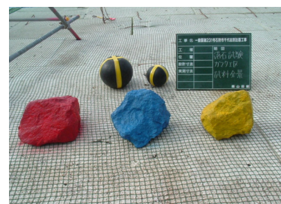
写真-3 現地落石実験の落石岩体試験体
