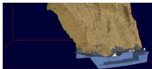
図-12 岩体の反発係数を用いた場合の落石停止位置
