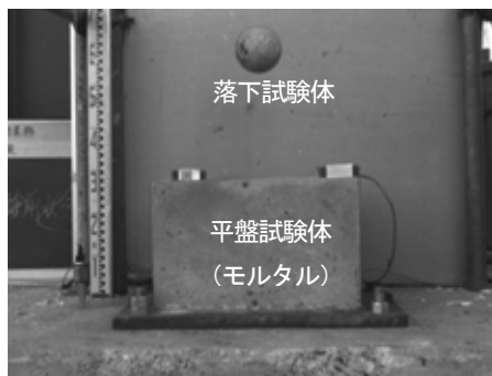
写真-1 屋内試験状況（自由落下試験）
