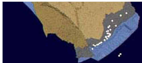
図-13 岩球体の反発係数を用いた場合の落石停止位置
