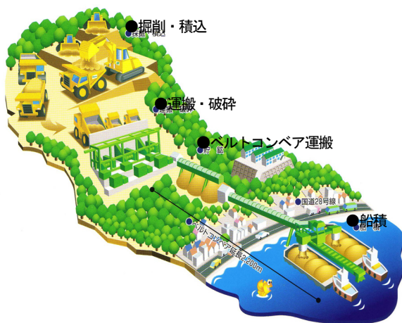
図-1 採土現場の作業概要
