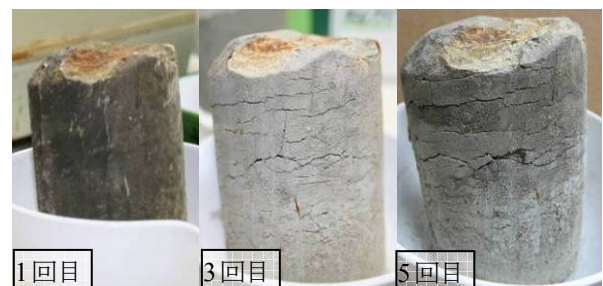
図-11 繰返し回数増加に伴う亀裂の変化（恒温室）
