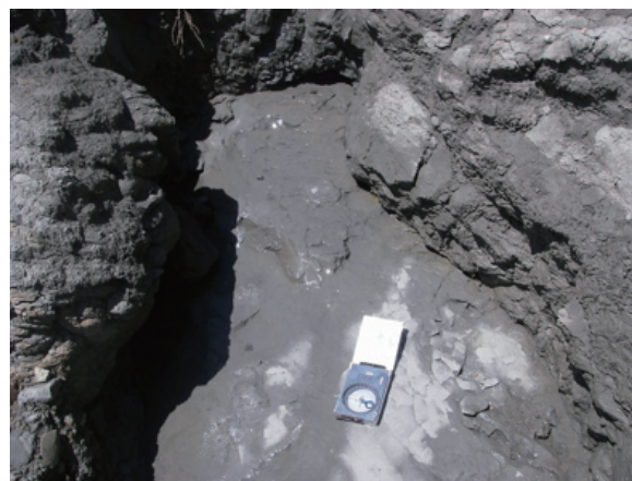
図－8 岩塊のすべりを生じた層理面
