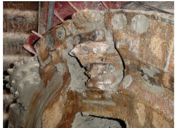
写真-8 中間貫通立坑におけるカッタービット磨耗状況
