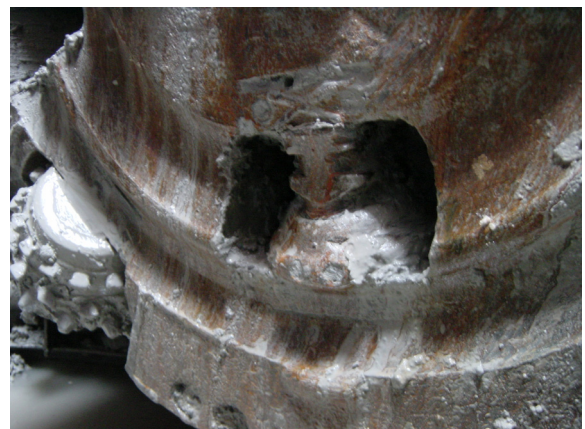
写真-9 中間貫通立坑におけるカッタービット磨耗状況
