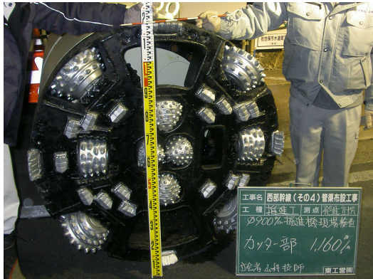
写真-2 φ900mm破碎型掘進機 (面盤タイプ)
