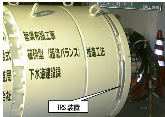
写真-4 TRS装置（掘進機取付）
