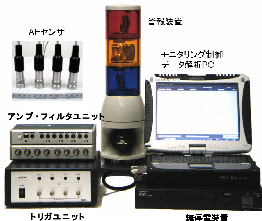
写真-2 モニタリングシステムの外観
