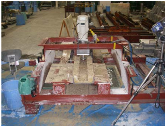
図-6 掘削装置の外観（写真）
