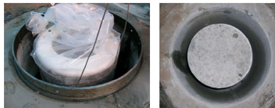
図-5 掘削完了したモルタル試験体（写真）
