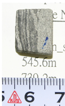
図-4 砂岩とシルト岩互層の供試体写真（測定前）とその内部空隙細孔半径測定結果。
