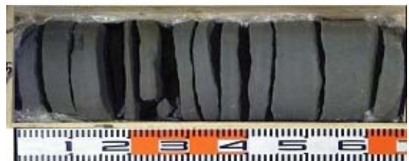
図-5 コアディスクング写真 (天端深度5.0m~5.7m)
