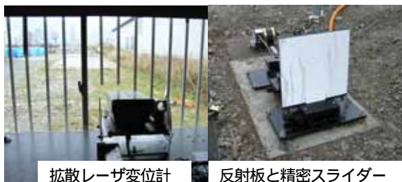
写真-2 野外実験における計測システムの外観
