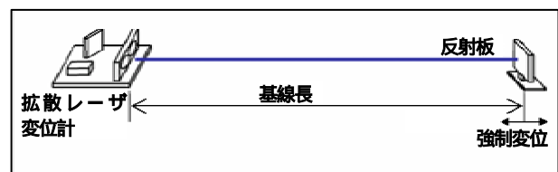
図-2 室内実験における計測システムの設置概要図
