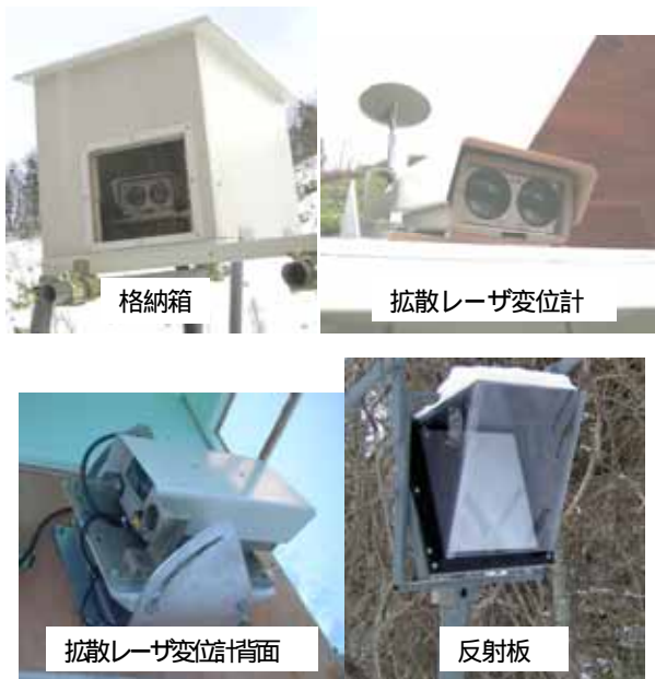
写真-1 拡散レーザ変位計システムの外観
