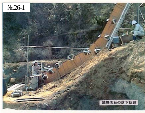
写真-1 落石現地模型実験の実施状況
