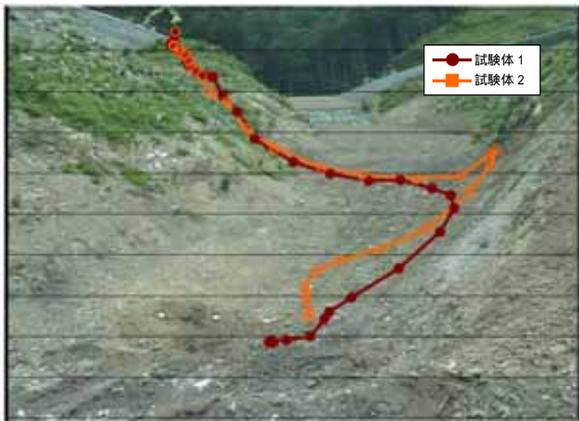
図 - 1 落石軌跡図 (実験)
