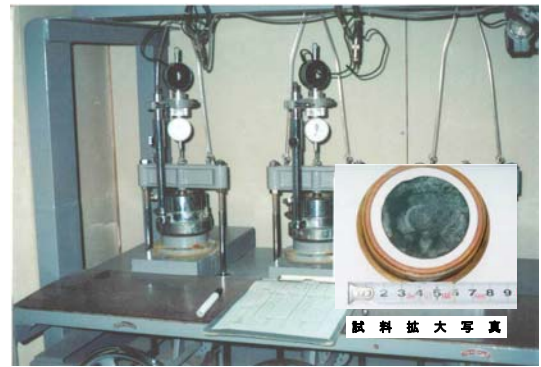
写真-1 除荷試験装置と供試体状況
