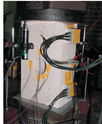
図－２ 空洞モデル（No.3, AE, BE, CE）と計測センサー配置状況
