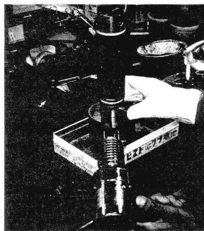
図-3 ジャケットに水が満たされた状態で熱収縮させるので、供試体は気中に曝されない
